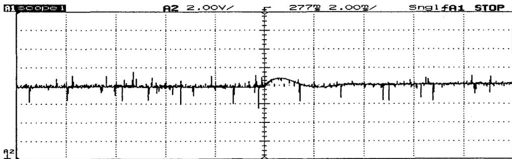
(d) Experimental output performance for 100% negative load disturbance ( $V_i=6V$ )
