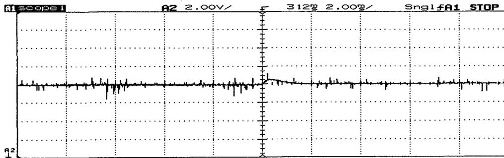
(d) Experimental output response for negative load disturbance
