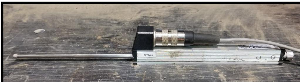
**FIGURE 2.34: TRS-100 POSITION TRANSDUCER**
