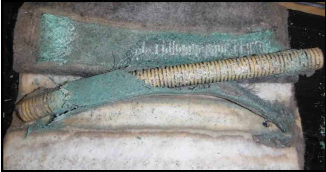
**FIGURE 1.1: ANODE OF SYSTEM AFTER TESTING SHOWS HIGH LEVEL OF CORROSION [14]**
