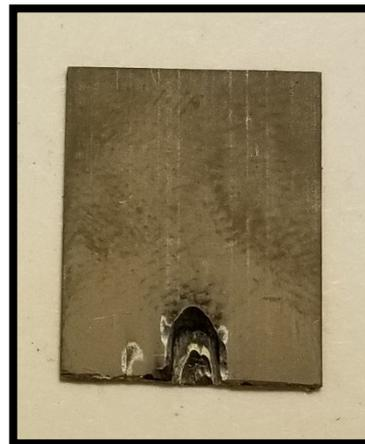
**FIGURE 2.10: BENDER ELEMENT WITH STEEL SHIM EXPOSED**
